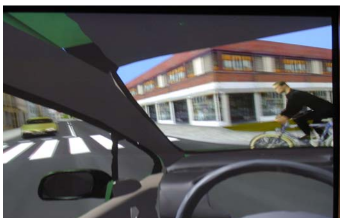
Simulation d'architecture du poste de conduite : vue par casque de visualisation immersive (Renault, CTS)
