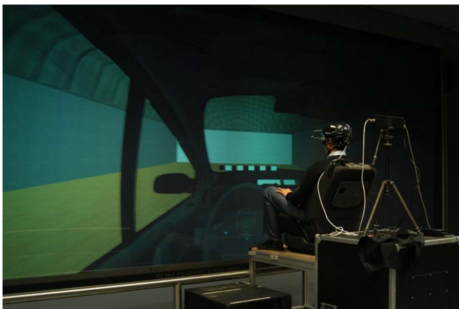
Simulation d'architecture du poste de conduite : système de projection à large champ de vision : (Renault, CTS)
